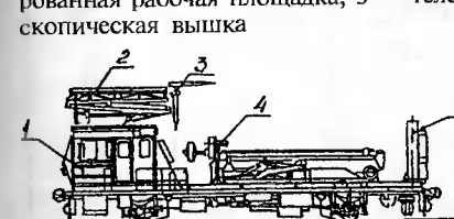
Рис. 1.1.7. Автомотриса АДМ-1С: 1 — кабина; 2 — неизолированная рабочая площадка; 3 — телескопическая вышка; 4 — буровая установка; 5 — кран-манипулятор
