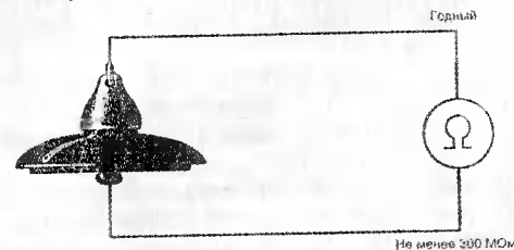
Рис. 19.6.4.4.1. Испытание фарфоровых тарельчатых изоляторов мегаомметром на 2,5 кВ
